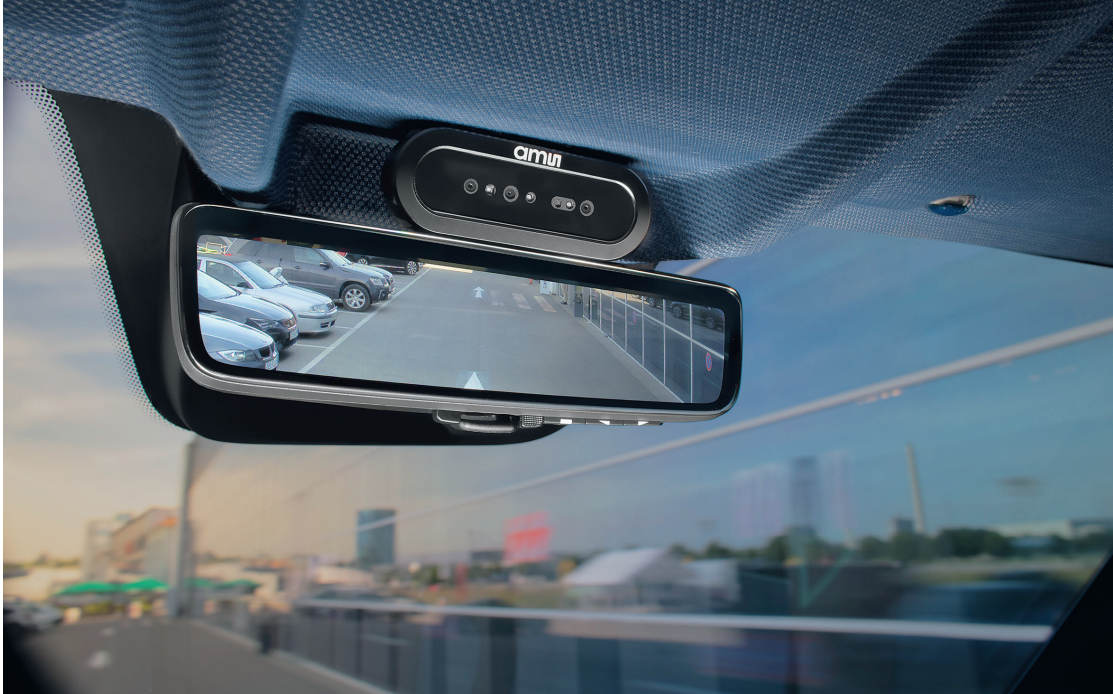
Bild 1: Der digitale Rückspiegel von Gentex sorgt für bessere Sicht nach hinten auch für leichte Nutzfahrzeuge. © Gentex
